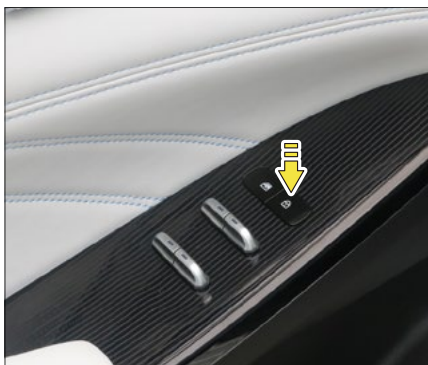
Interruttore centrale interno di blocco delle portiere
