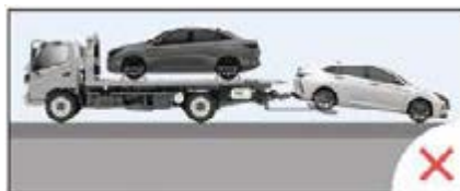
Esempio di traino errato del veicolo
